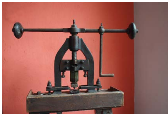
fig C. Presse à balancier pour le décolletage du métal laminé, elle utilise ici des matrices en forme d'étoile. Dépôt Commeiras au musée Gassendi
